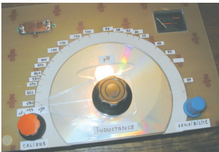
Vue face avant du boîtier, avec en haut à gauche les contacts de TEST ; en bas à gauche le sélecteur x 1 ; x 0,1 ; x 0,01 \mu H
