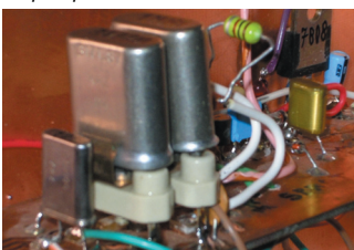
Derrière la face avant, on trouve le CV Au centre ; la pile 9 V à gauche et au Dessus du CV, la platine supportant les 3 quartz commutables et l'électronique qui va bien.
